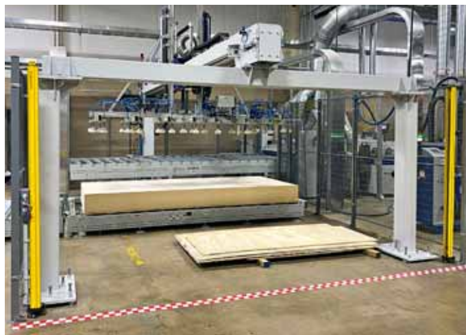
Installierte Portal-Beschickung mit Schonplatten-Ablage. Positioniert vor einer Platten-Reinigung und Beschichtungsanlage bei einem bekannten Plattenveredler. Version wie auf den CAD Zeichnungen erkennbar (1 bis 3)
