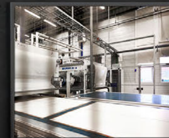
Hochflexible Durchlaufpressenanlage für Wandpaneelen
