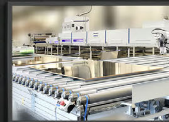
Sorgt für hochglänzende Oberflächen - Lackieranlage für die Beschichtung melaminbeschichteter Spanplatten
